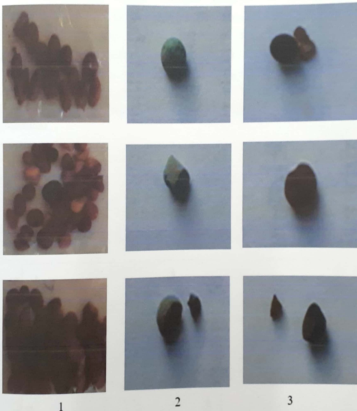
3.6-rasm. Sorbentlar eritma tarkibidagi metall ionlarini yuturilishi natijasida rangi o'zgarishi. (A)SG-DK01, (B)SG-DK02, (C)SG-DK04, 1-Cu(II), 2-Ni(II) ionlarining sorbsiyasi
